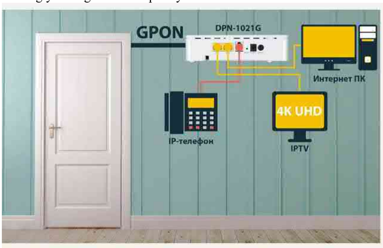
3.2-rasm. GPON texnologiyasi asosida internetga ulanish
