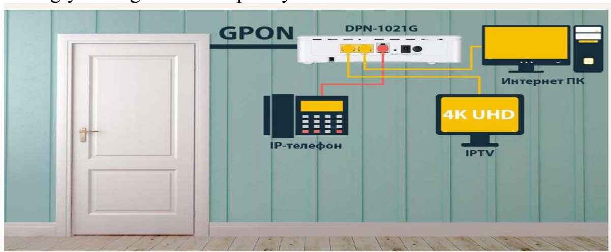
3.2-rasm. GPON texnologiyasi asosida internetga ulanish
